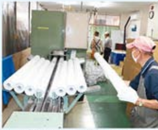
⑤TPカット機にセット
